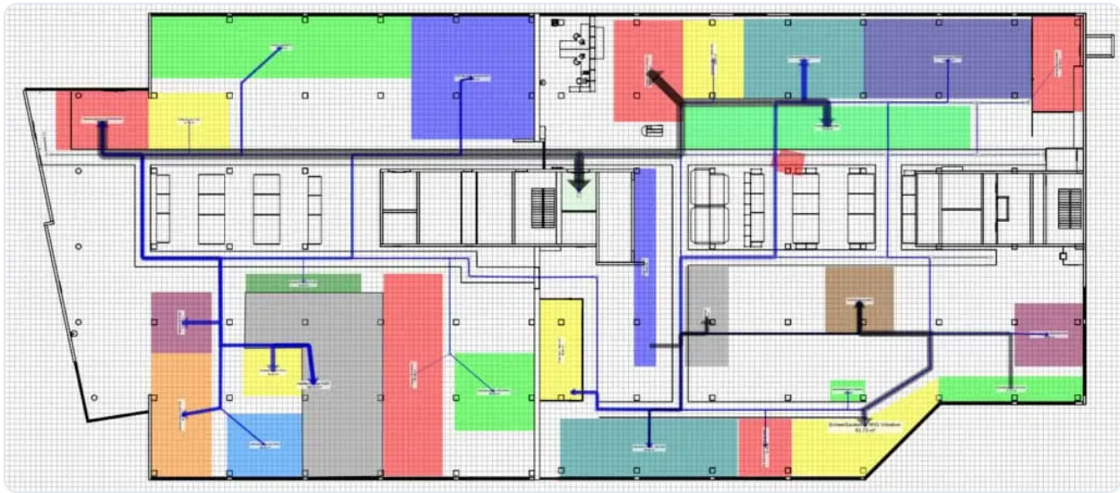
Visualisierung und Bewertung der Materialflüsse in der IST-Analyse mit visTABLE®touch.
